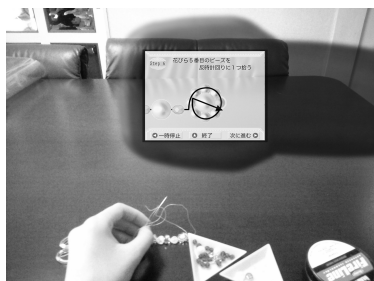
図3. 作業中の視界のイメージ図 Nikon UPは視角24度、1m先に17型程度のイメージサイズ
