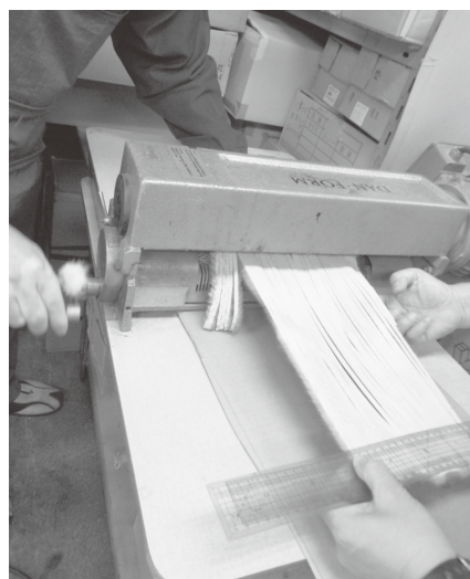
図1 中村毛皮貿易株式会社のミンク裁断機
