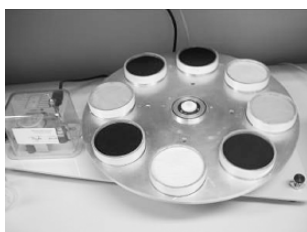
Fig.6 透湿性測定装置
