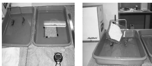
Fig.9 懸垂法測定風景
