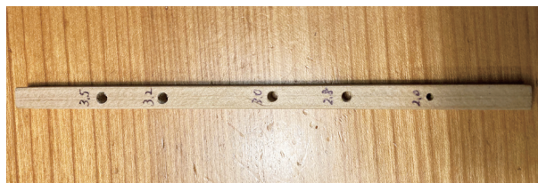
図11 檜材に5段階の孔を開け強度を比較
