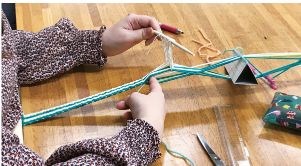
図13 輪状綜統による開口装置。
