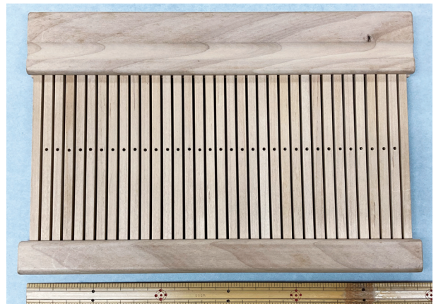
図5 初号機（製作 保坂家具）2002年（H197×W293×D19mm, 経密度2.5本/cm, 板幅 6.0mm, 孔径2.5mm, 隙間2.0mm）
