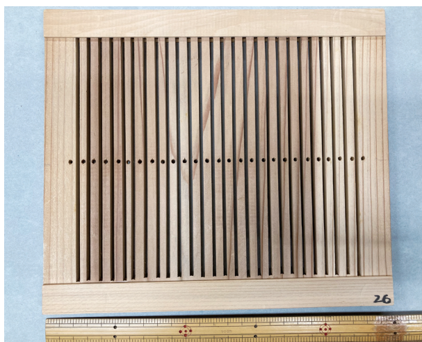
図7 2号機(製作 東京木材青年組合)2003年: H212×W247×D11mm, 経密度2.5本/cm, 板幅 5.5mm, 孔径3.0mm, 隙間2.5mm
