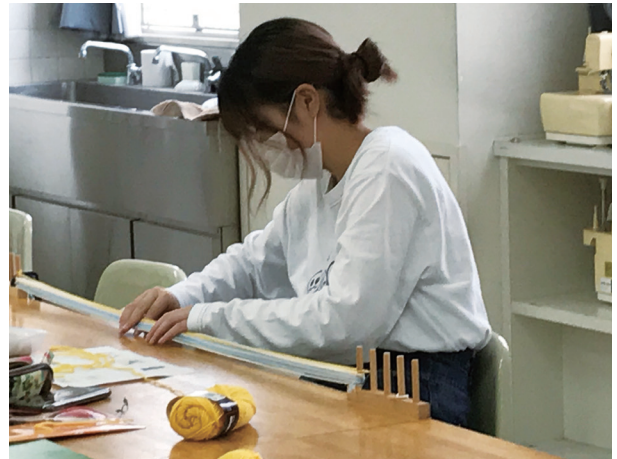
図15 簡易整経台による整経
