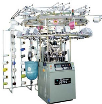
Fig. 2.7 イタリアの SANTONI社の SM8TOP2 (Circular knitting machine) 12)
