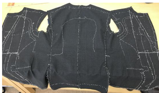
図6 芯据え (仮縫い前)
