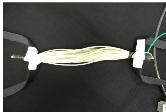
写真4 空気を入れた後の人工筋肉
