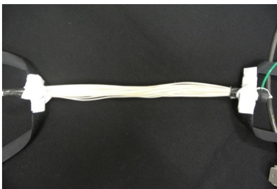
写真3 空気を入れる前の人工筋肉
