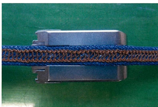
図8 カバーステッチ専用押えとベルトループ（裏面）
