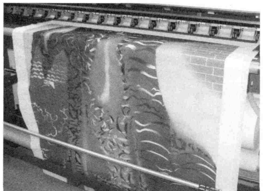
図 6. インクジェットによるプリント 前処理済みのシルクシフォンに、酸性染料でプ リント中のスカーフ (ミマキ Textile Jet Tx2- 1600)。
