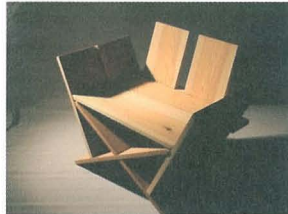
16. 胡座イス：相欠、差込、楔止めを用い、背板の反りを活かした
