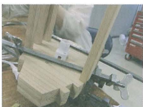
15. 「反り」が発生しないようにするには、2枚の材料を重ねて使用することが有効であることがわかった
