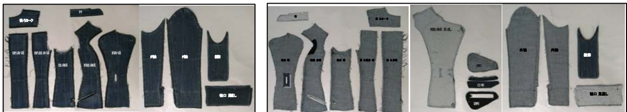
図 5 試料の 2 次分解(ジャケット分解結果)
